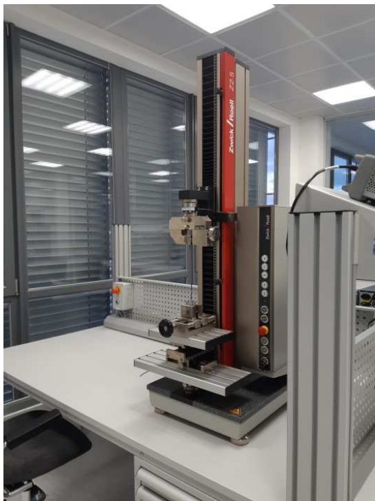
Испытание на извлечение проводника из клемм
