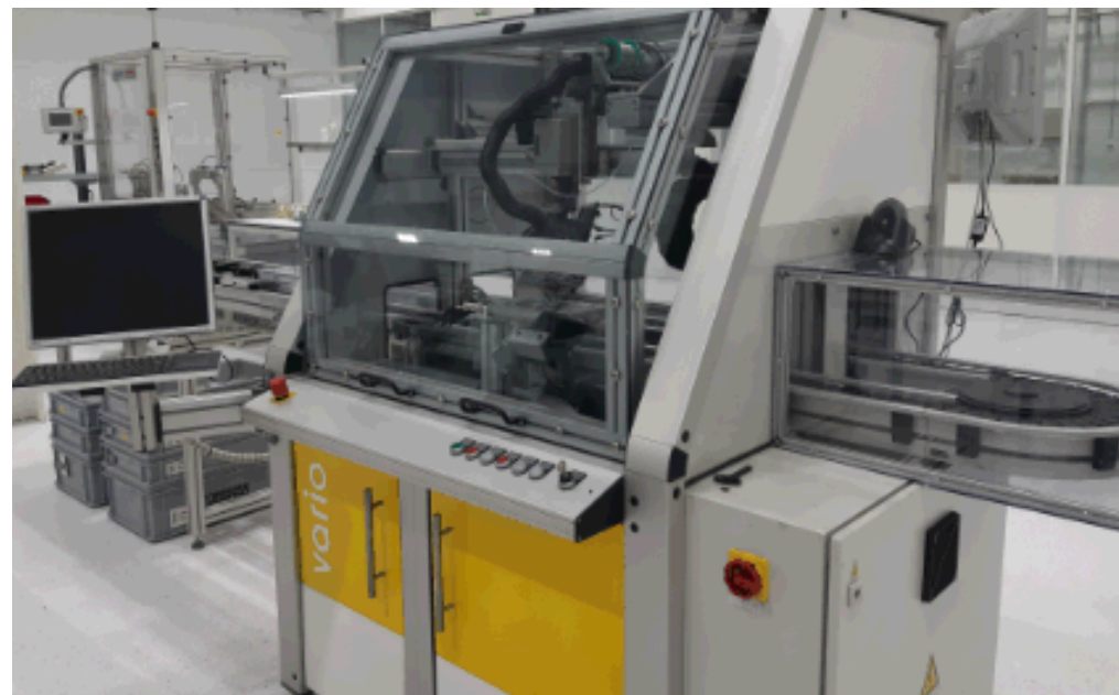
Линия пайки PLC и УЗИП контактов
