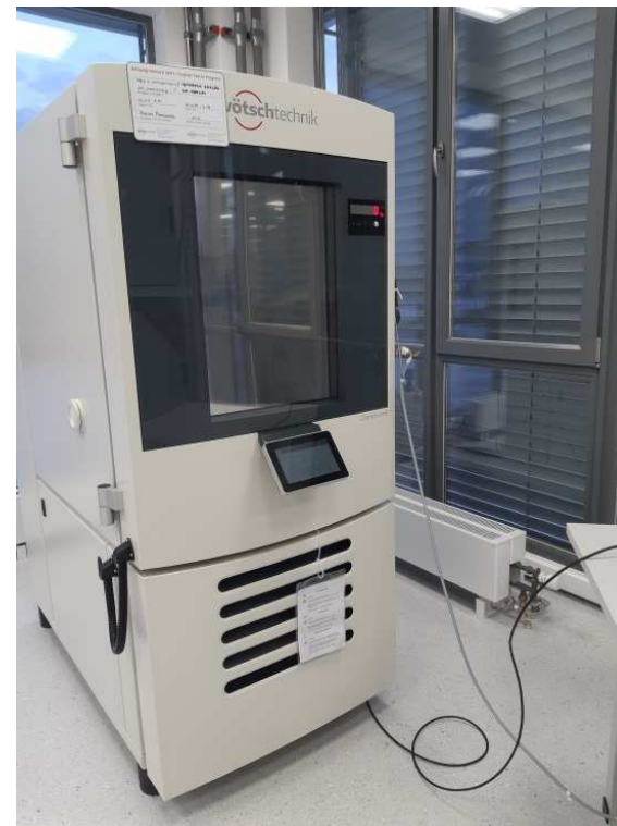
Испытание на ускоренное старение
