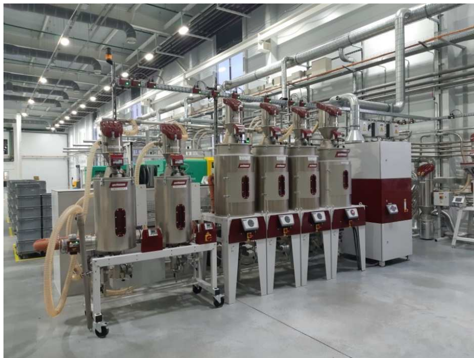
Участок подготовки пластикового гранулята
