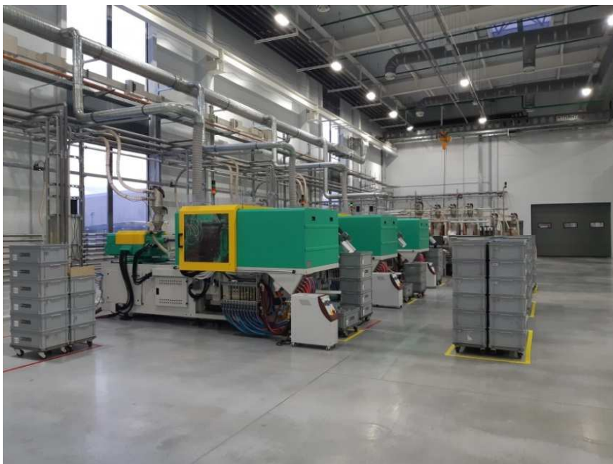
Литьё пластиковых корпусов клемм
