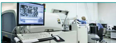
05 Неразрушающая инспекция монтажа АОИ
