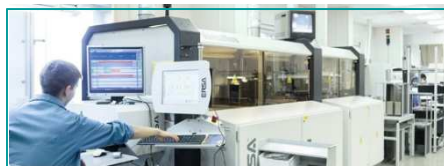
03 Селективный автоматизированный монтаж объёмных компонентов (DIP)
