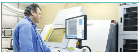
10 Рентген-контроль сборки и финишных операций, неразрушающий контроль соединений JTAG
