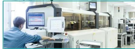
**03** Селективный автоматизированный монтаж объёмных компонентов (DIP)
