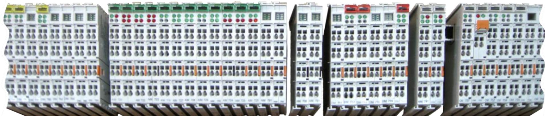
Внешние интерфейсные, дискретные и аналоговые сигналы подключаются к модулям ввода-вывода. Модули позволяют подключать датчики и исполнительные механизмы, имеют цепи гальванической развязки и индикаторы состояния каналов.
