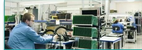
**04** Ручная установка и формовка нестандартных компонентов, ремонт и восстановление
