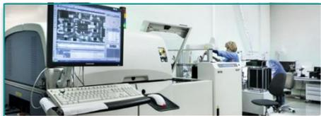
**05** Неразрушающая инспекция монтажа АОИ
