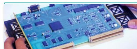
**08** Ультрафиолетовая инспекция нанесенных влагозащитных покрытий
